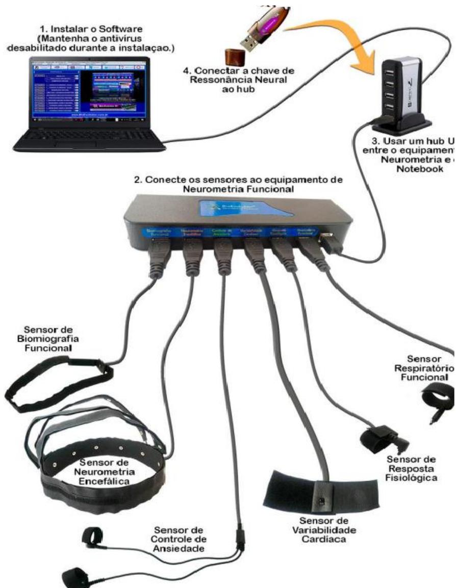
Figura 5. Equipamento de Neurometria e periféricos.
